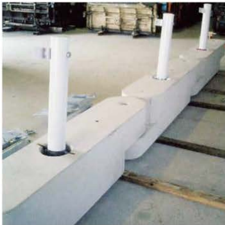
支柱を固定する前に、ビームを組み立てることができるので、加工時間を短縮できる。
